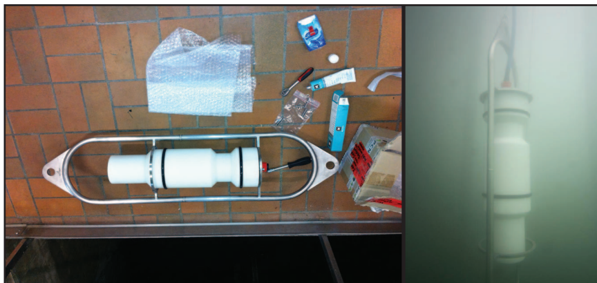
Figure 2 : Installation d'une sonde de mesure aquatique
